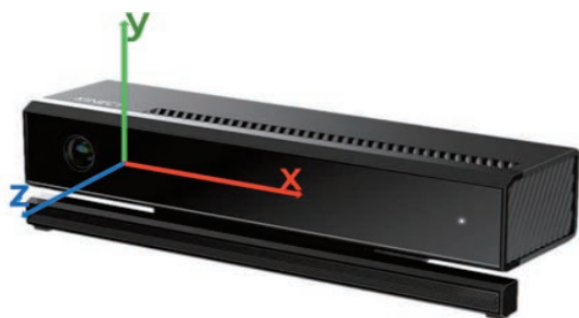
図3 Kinect による三次元座標
