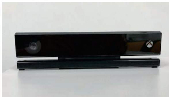
図1 Kinect (縦65mm、横245mm、厚さ68mm)
